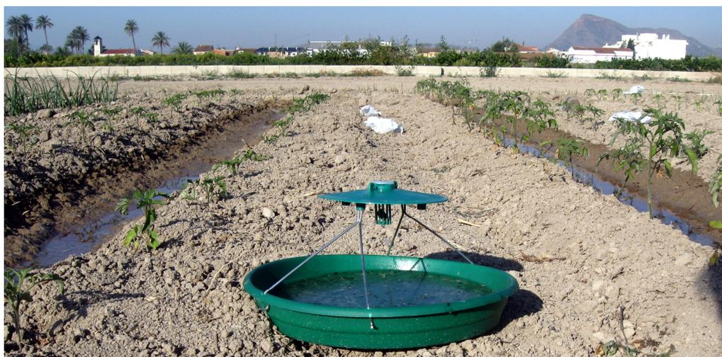
**ECONEX ARMADILHA DE ÁGUA INSTALADA EM CAMPO**
